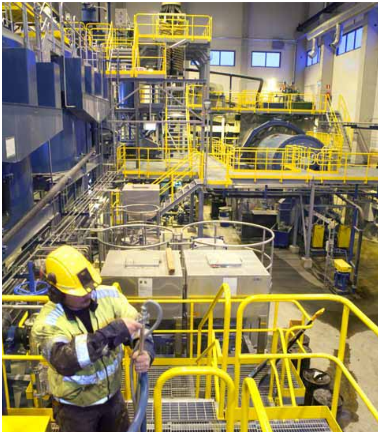
Flotationsceller till vänster med kvarnen i bakgrunden.
